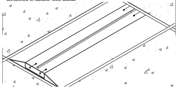
6.) SLIDE RETROFIT HOUSING SIDE FLANGES UNDER THE SIDE FLANGES OF THE EXISTING HOUSING. FLANGE ON THE RETROFIT SHOULD REST BETWEEN THE FLANGE OF THE EXISTING HOUSING AND THE GRID. SECURE RETROFIT HOUSING TO RETROFIT END USING SCREWS PROVIDED.
